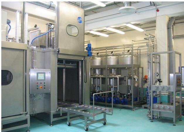
Mehrstufige Filtration, Schmutzabtragungsbander, Anlagen-Selbstreinigung mit CIP-Programm sind die wesentlichen Merkmale unserer Anlagentechnik in hygienic design.
