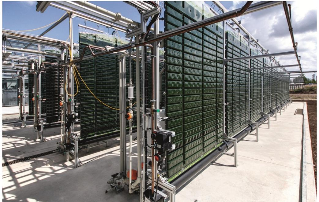
180-Liter-Reaktormodule der Freilandanlage am Fraunhofer CBP in Leuna
